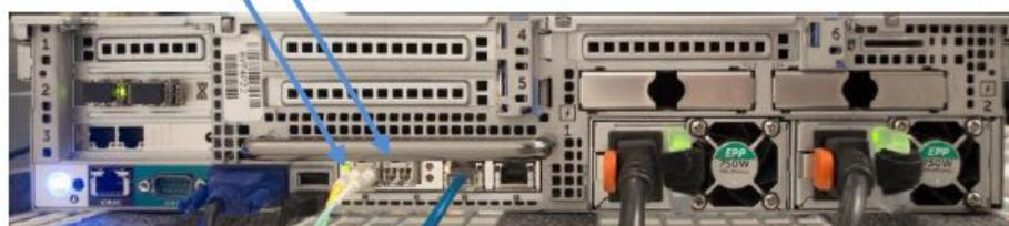
2. En la parte posterior del dispositivo de captura de paquetes, conecte el puerto de interfaz de clúster de la izquierda del maestro con el puerto de interfaz de clúster de la izquierda del primer nodo de datos, tal como indican las flechas de los diagramas precedentes.
