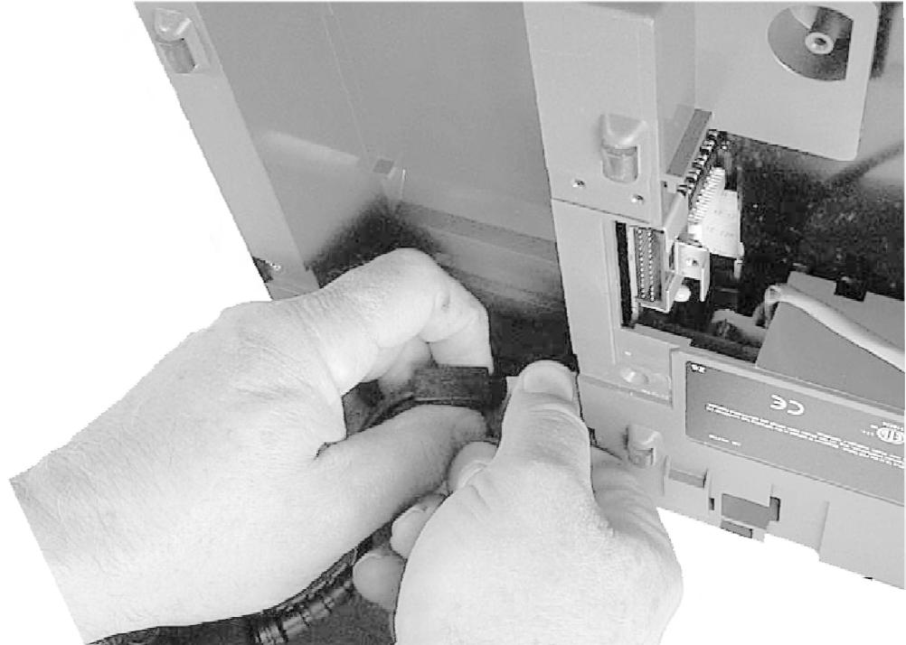
*Figura A-10. Afloje los conectores y extraiga la fuente de alimentación*
