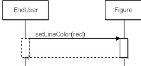
図 23: メソッド呼び出しとメソッド応答
