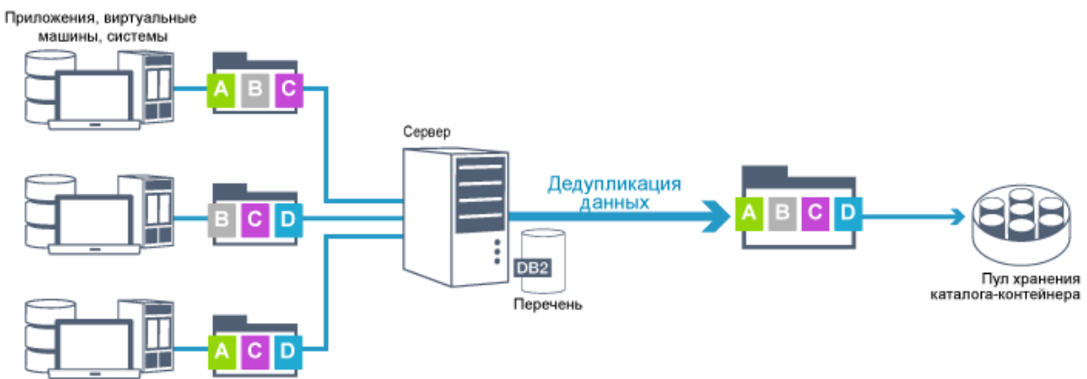
Рис. 1. Процесс дедубликации данных
