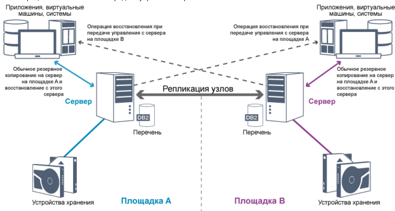
Рис. 1. Процесс автоматической передачи управления при отказе
