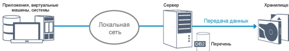
Рис. 1. Операции резервного копирования IBM Spectrum Protect через LAN
