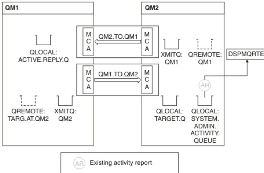
그림 18. 시스템 큐에 활동 보고서 전달, 다이어그램 2
