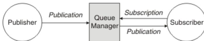
Figura 17. Configurazione di pubblicazione / sottoscrizione semplice
