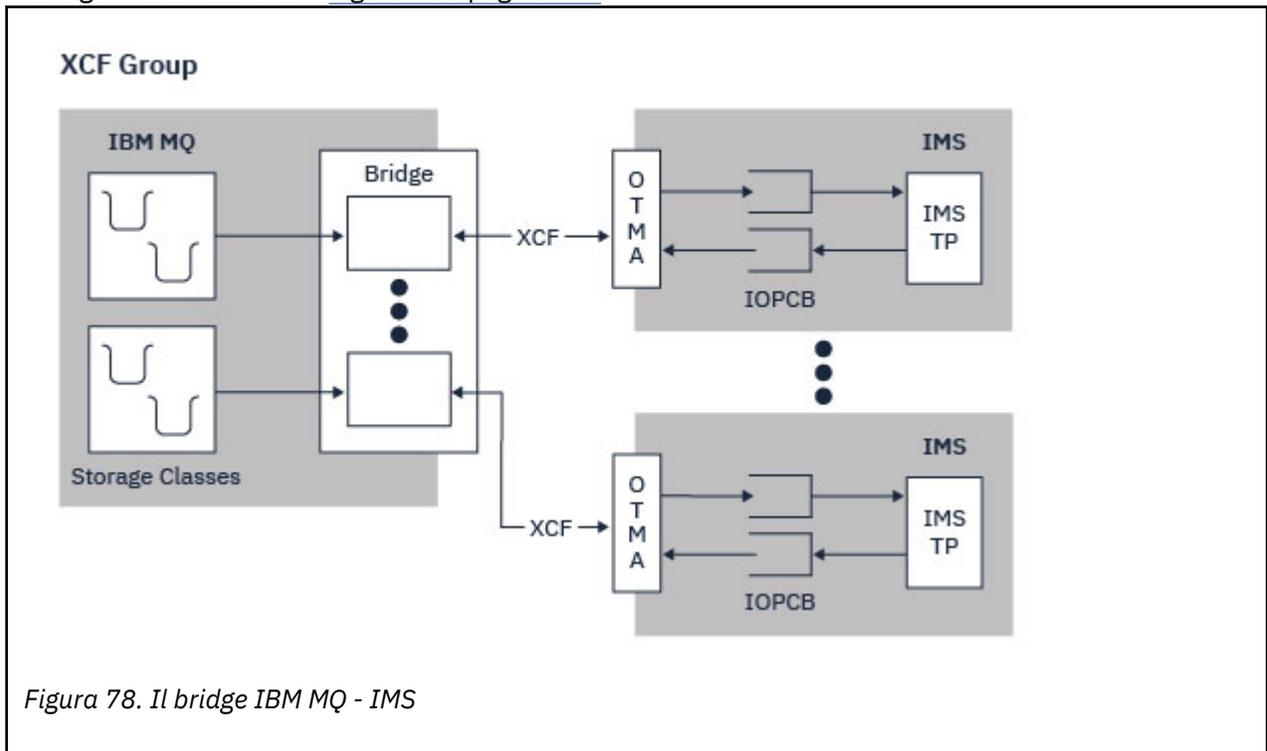
Figura 78. Il bridge IBM MQ - IMS
