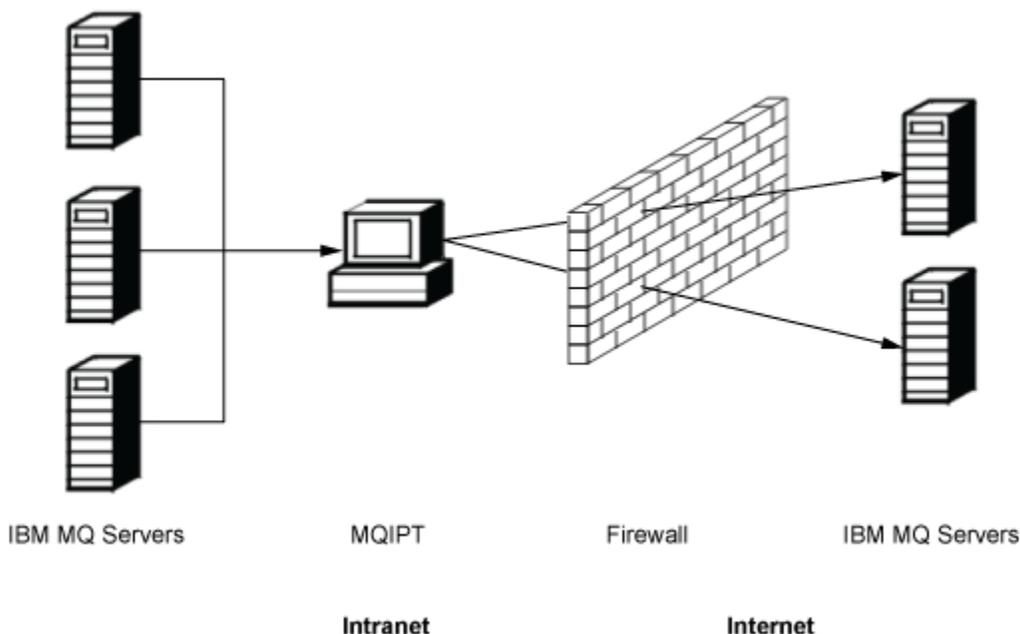
Figura 79. Esempio di MQIPT come concentratore di canale
