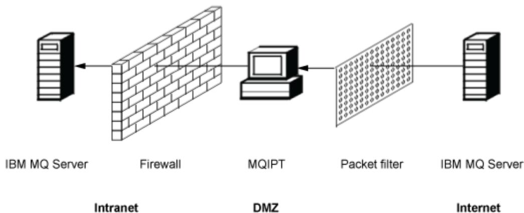
Figura 80. Esempio di MQIPT in un firewall DMZ
