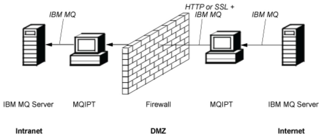
Figura 81. Esempio di tunneling MQIPT e HTTP
