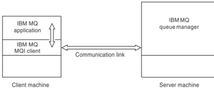
Figura 51. Collegamento tra un client e un server
