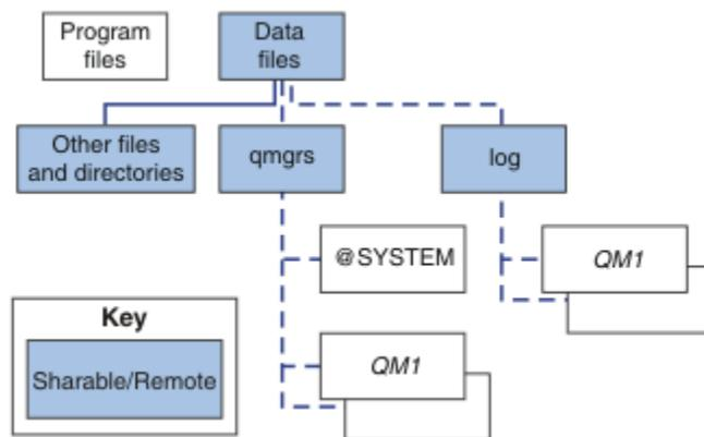
*Figura 32. Visión general de la estructura de directorios de IBM MQ*
