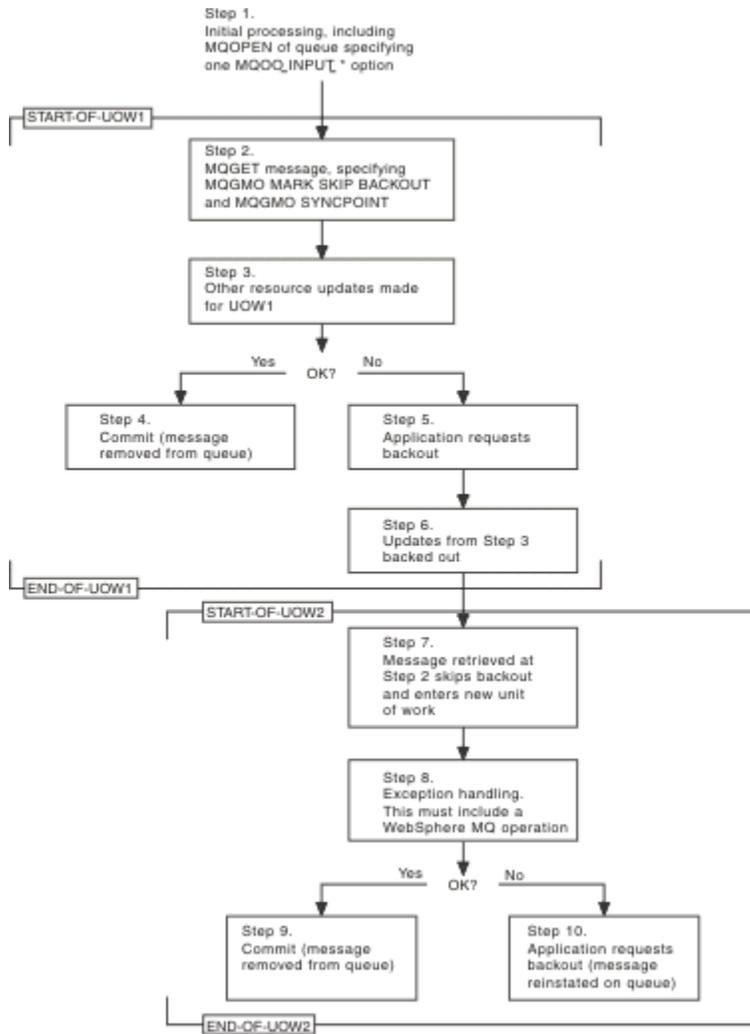
图 63: 使用 MQGMO\_MARK\_SKIP\_BACKOUT 跳过回退
