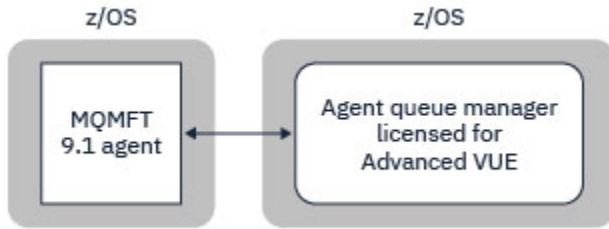
Şekil 44. z/OS üzerindeki MFT 9.1 araçları, kuyruk yöneticisinin Advanced VUE için lisanslandığı varsayılarak, CLIENT iletimini kullanarak bir kuyruk yöneticisine bağlanabilir.
