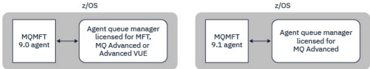
Şekil 45. MFT ya da IBM MQ Advanced için lisanslı bir aracı kuyruk yöneticisi olan z/OS ve 9.1 araçlarında MFT 9.0 araçları, BINDINGS iletimini kullanarak bağlanmalıdır.
