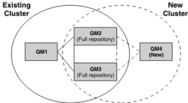
**참고:** 전체 저장소를 연결하는 IPv4 및 IPv6 정의가 모두 있으므로 신규 또는 기존 클러스터 정의 모두에 대한 정의가 서로 중복됩니다. 또한 큐 관리자 QM1 및 QM4는 공용 네트워크를 공유하지 않으므로 직접 통신할 수 없습니다. 예를 들어 큐 관리자 QM2 및 QM3에 정의된 알리아스 큐를 사용하여 간접적으로 통신할 수 있습니다. 위에 표시된 구성에서 라우트를 수정하는 데 BIND\_OPEN을 사용하게 될 경우 다중 라우트가 존재하므로 QM2 및 QM3 간의 응용프로그램 메시지 플로우 순서에 주의해야 합니다.
