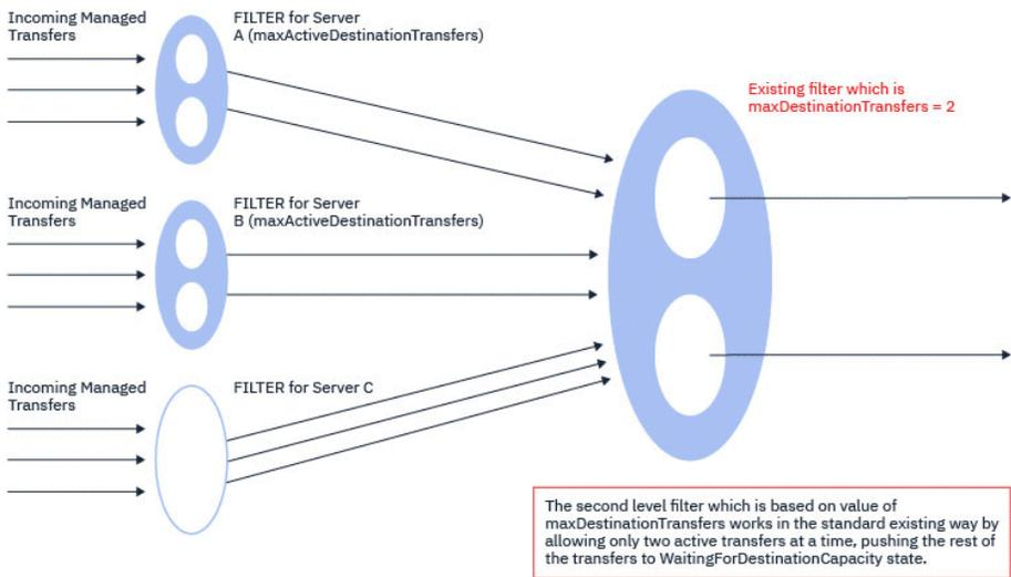
図が示すように、**maxActiveDestinationTransfers** 属性と **maxDestinationTransfers** 属性は互いに独立しています。
