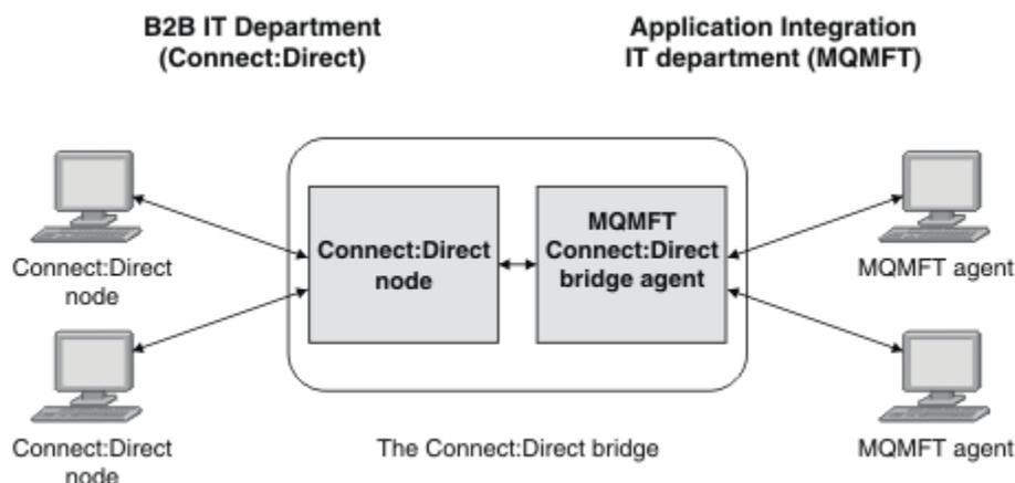
この図は、2つの部門、B2B IT 部門、およびアプリケーション統合 IT 部門の間の MFT Connect:Direct ブリッジを示しています。B2B IT 部門は、Connect:Direct を使用して、会社のビジネス・パートナーとの間でファイルを転送します。アプリケーション統合 IT 部門では、IBM MQ をメッセージング・インフラストラクチャーとして使用するため、最近ファイル転送ソリューションとして Managed File Transfer を選択しました。
