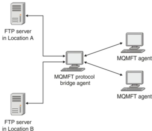
この図は、異なるロケーションにある2つのFTPサーバーを示しています。FTPサーバーは、Managed File Transfer エージェントとファイルを交換するために使用されています。プロトコル・ブリッジ・エージェントは、FTPサーバーと、MFT ネットワークの残りの部分との間にあり、両方のFTPサーバーと通信するように構成されています。
