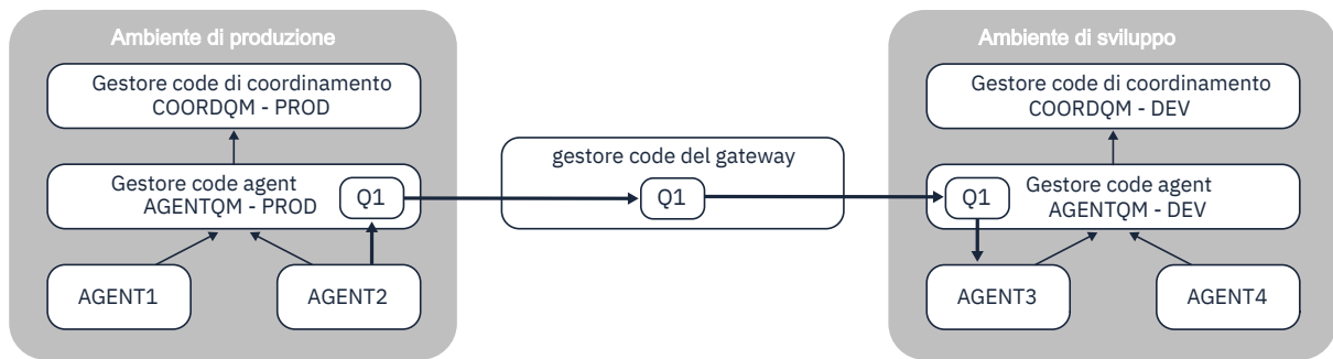
Figura 8. Qui, AGENT2 è connesso al relativo gestore code dell'agent AGENTQM - PROD ed esegue un trasferimento file - a - messaggio per scrivere un messaggio in una coda denominata Q1. Q1 è una coda remota e quindi il messaggio viene instradato tramite il gestore code gateway e i canali mittente / destinatario alla coda locale Q1 sul gestore code AGENTQM-DEV. AGENT3 esegue quindi un trasferimento da messaggio a file per ottenere il messaggio e portarlo nella topologia dell'ambiente di sviluppo.
