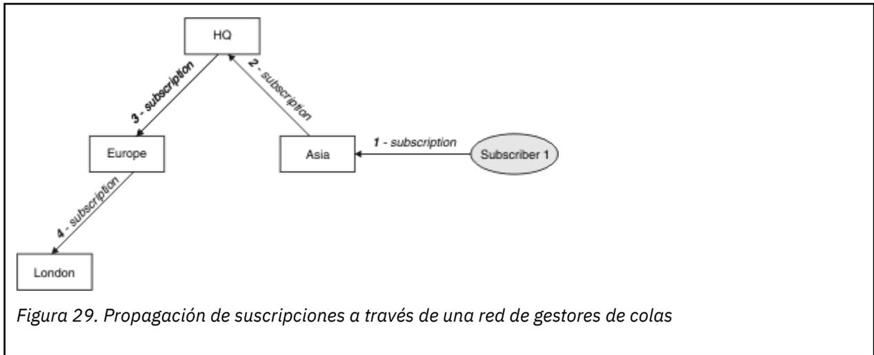
Figura 29. Propagación de suscripciones a través de una red de gestores de colas
