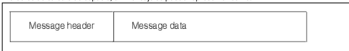
La sección de cabecera del mensaje contiene el descriptor de mensaje y otra información de control, el tamaño del cual varía según el tamaño del mensaje. La sección de datos de mensaje contiene todos los datos del mensaje reales y cualquier otra cabecera (por ejemplo, la cabecera de transmisión de la cabecera de puente de IMS).
