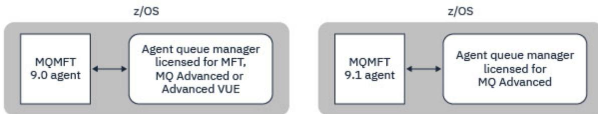
Figura 45. Los agentes de MFT 9.0 en agentes z/OS y 9.1 que tienen un gestor de colas de agente con licencia para MFT o IBM MQ Advanced deben conectarse utilizando el transporte BINDINGS.
