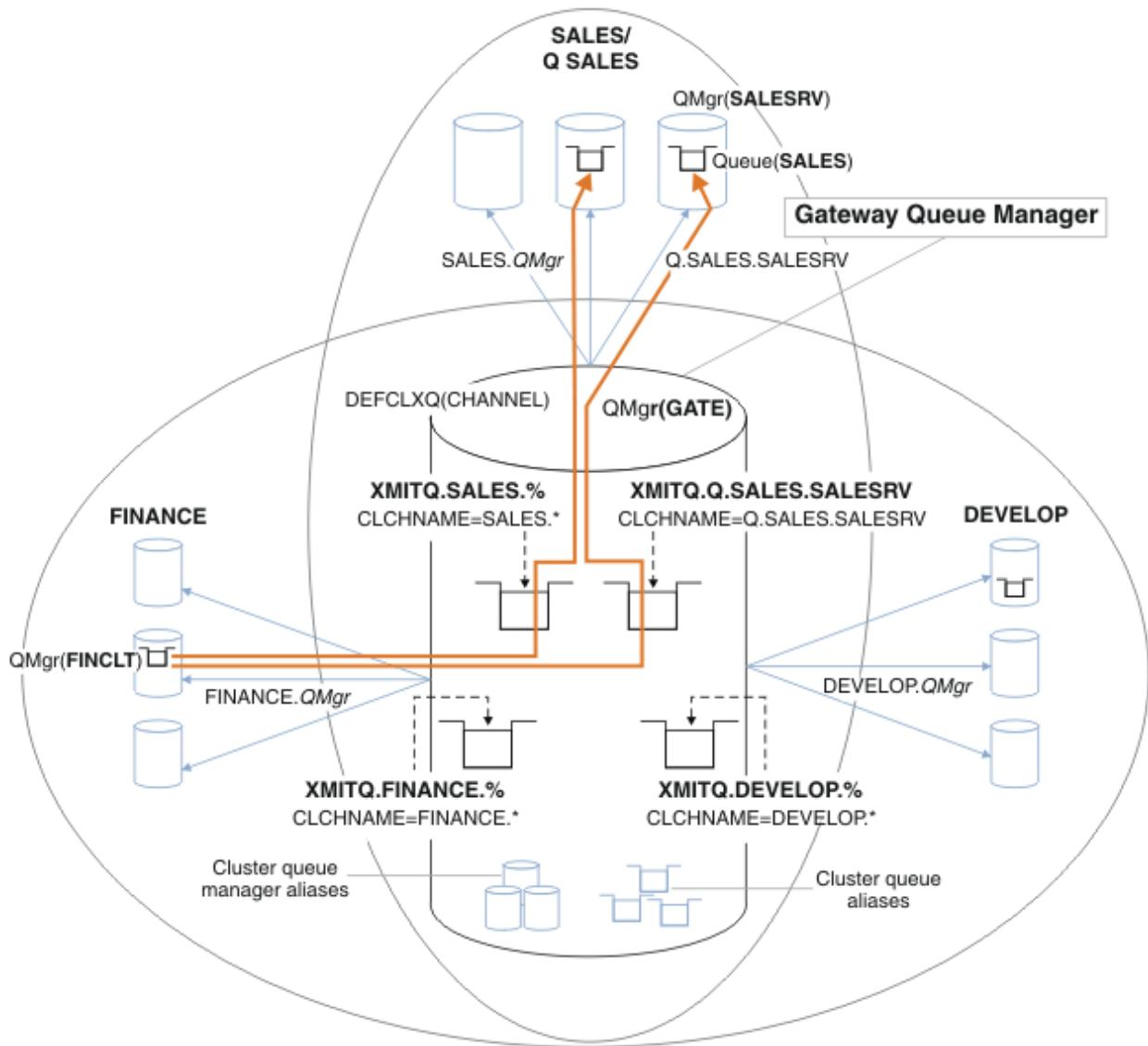
圖 13: 不同部門 IBM MQ 叢集的特定傳輸佅列範例
