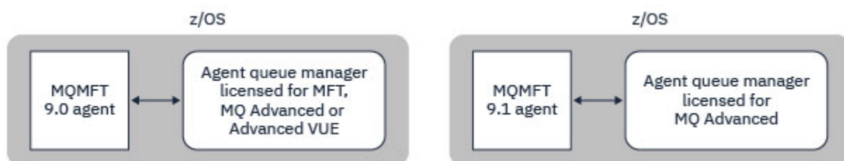
圖 45: z/OS 及 9.1 代理程式上的 MFT 9.0 代理程式 (具有授權 MFT 或 IBM MQ Advanced 的代理程式佇列管理程式) 必須使用 BINDINGS 傳輸進行連接。
