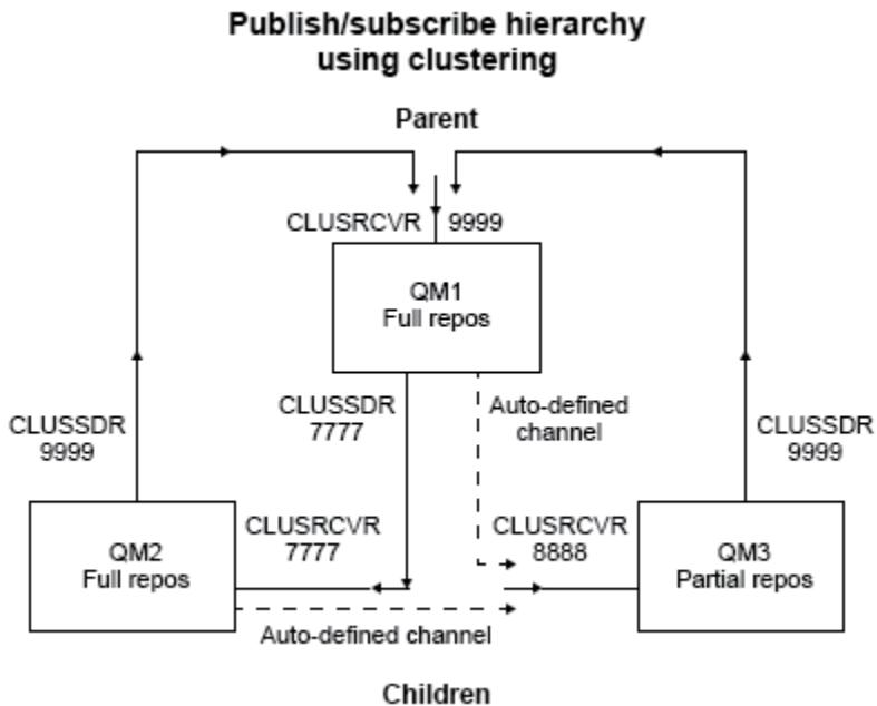
그림 5. 클러스터 채널을 사용 중인 큐 관리자 사이의 관계를 보여주는 토플로지 다이어그램.
