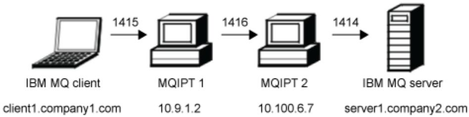
그림 31. SSL/TLS 서버 네트워크 다이어그램
