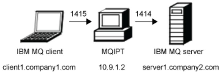
그림 40. SSL/TLS 프록시 모드 네트워크 다이어그램
