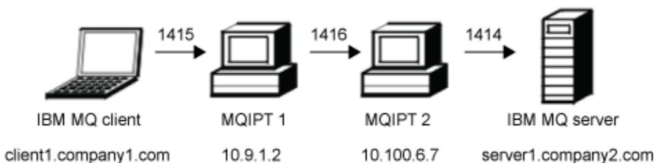
그림 45. SSL/TLS 서버 네트워크 다이어그램
