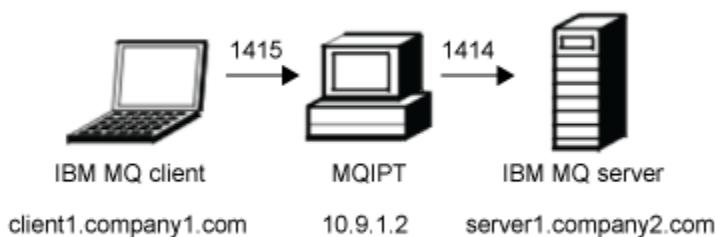
그림 30. 설치 확인 테스트 네트워크 다이어그램
