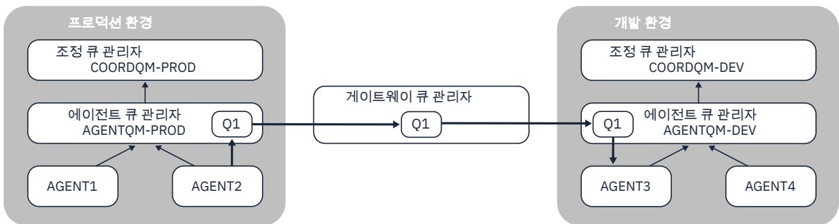
그림 8. 여기서, AGENT2 는 에이전트 큐 관리자 AGENTQM-PROD 에 연결되며 Q1 이라는 큐에 메시지를 쓰기 위해 파일 대 메시지 전송을 수행합니다. Q1 은 리모트 큐이므로 게이트웨이 큐 관리자 및 송신자/수신자 채널을 통해 큐 관리자 AGENTQM-DEV 의 로컬 큐 Q1 으로 메시지가 라우트됩니다. 그런 다음 AGENT3 은 메시지 대상 전송을 수행하여 메시지를 가져오고 이를 개발 환경 토폴로지로 가져옵니다.
