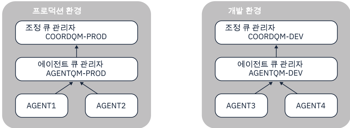
그림 6. AGENT1 및 AGENT2 는 프로덕션 환경에서 토폴로지의 일부이며, AGENT3 및 AGENT4 는 개발 환경 토폴로지의 일부입니다.
