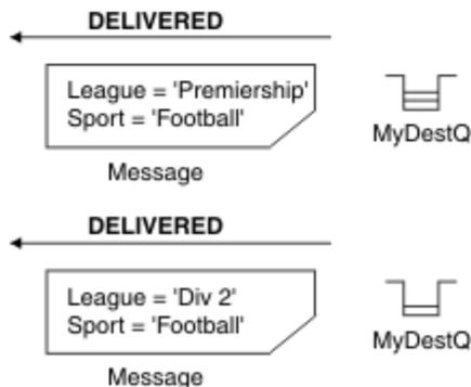
図 3. MQSUB 呼び出しを使用する選択
