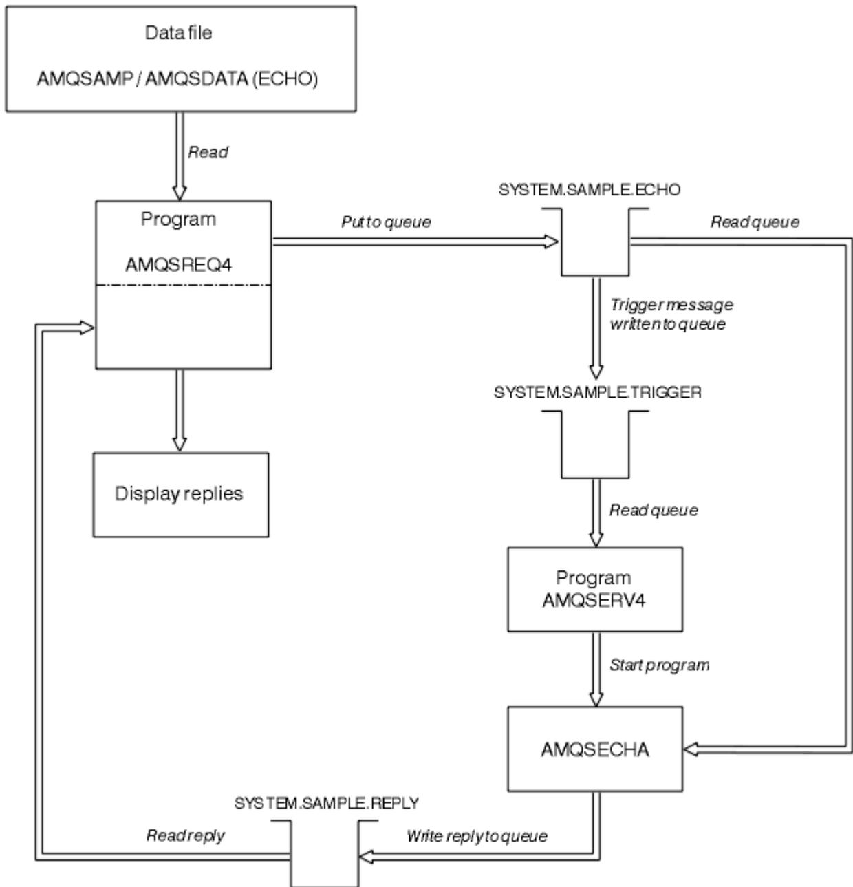
図 137. サンプル IBM i クライアント/サーバー (エコー) プログラムのフローチャート
