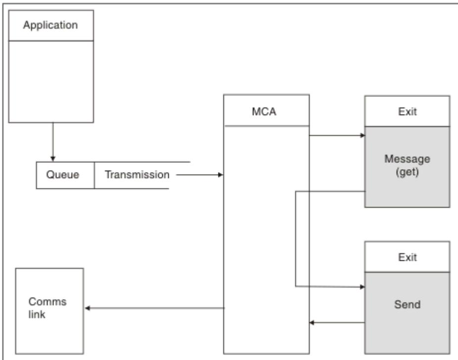
図 108. メッセージ・チャネルの送信側での送信出口の例
