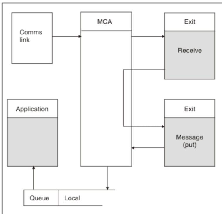
図 109. メッセージ・チャネルの受信側での受信出口の例
