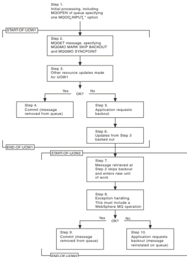
図 67. MQGMO\_MARK\_SKIP\_BACKOUT の使用によるバックアウトのスキップ
