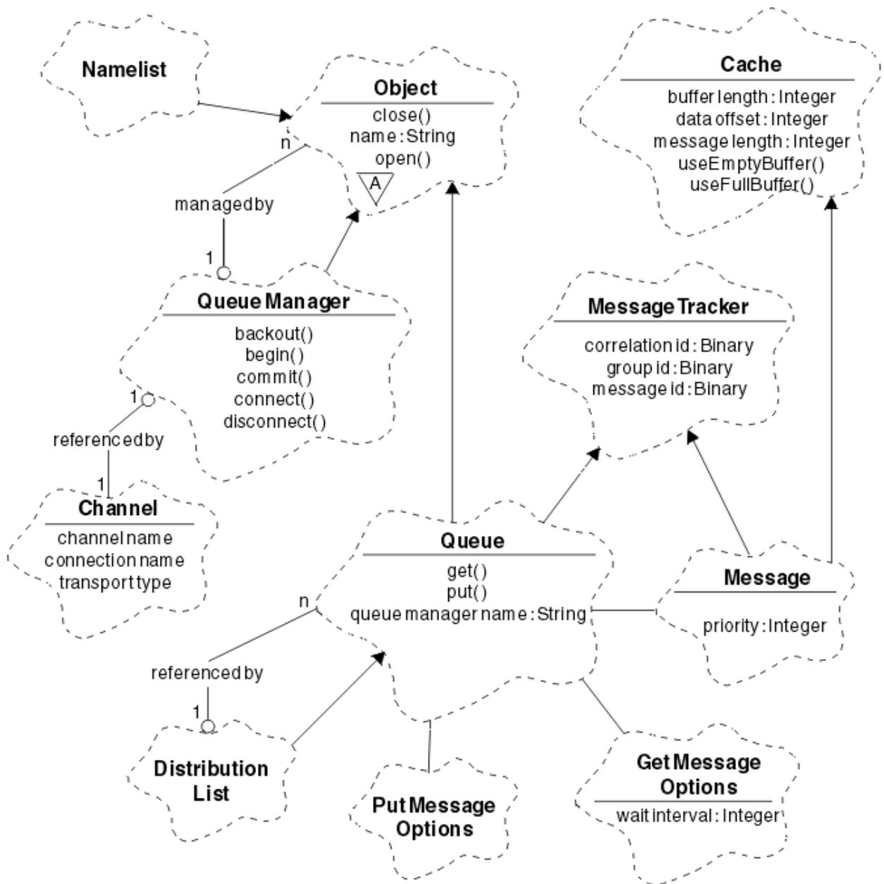
図 57. IBM MQ C++ クラス (キュー管理)
