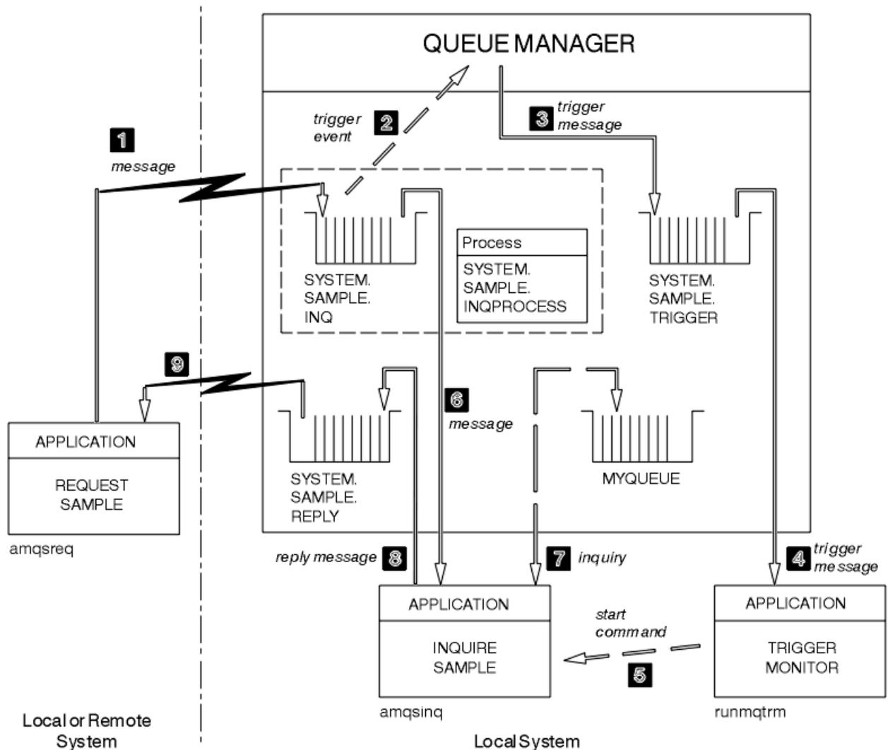
図 136. トリガー操作を使用する要求および照会サンプル
