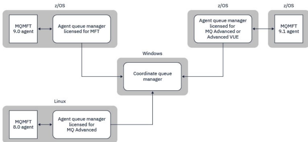
Figure 47. Les agents MFT s'exécutant sous z/OS peuvent faire partie d'une topologie MFT dans laquelle le gestionnaire de files d'attente de coordination s'exécute sur une multiplateforme IBM MQ .
