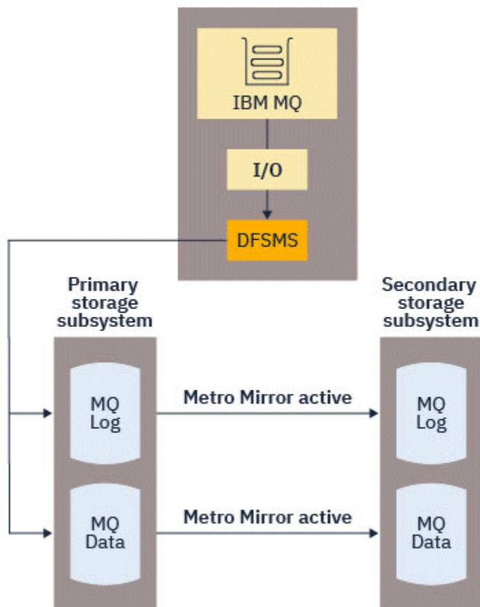
Etant donné que les deux écritures dans les sous-systèmes de stockage principal et secondaire doivent être terminées avant que l'écriture ne revienne à IBM MQ, l'utilisation de Metro Mirror peut avoir un impact sur les performances. Vous devez équilibrer cet impact sur les performances par rapport aux avantages de disponibilité liés à l'utilisation de Metro Mirror.
