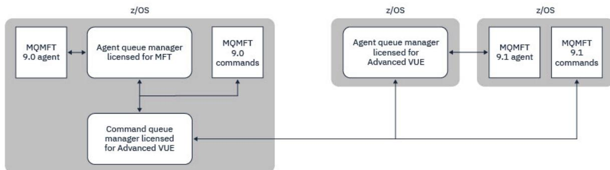
Figure 46. Les commandes se connectent au gestionnaire de files d'attente de commandes pour une topologie MFT. Lors de l'exécution de ces commandes sous z/OS, le gestionnaire de files d'attente de commandes doit également être sous z/OS
