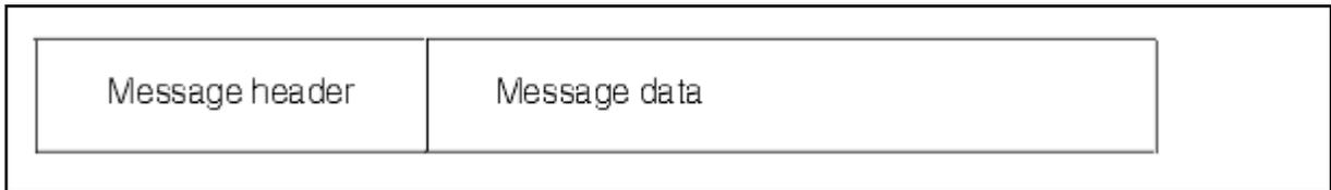
La section d'en-tête de message contient le descripteur de message et d'autres informations de contrôle, dont la taille varie en fonction de la taille du message. La section des données de message contient toutes les données de message réelles et tous les autres en-têtes (par exemple, l'en-tête de transmission ou l'en-tête de pont IMS).
