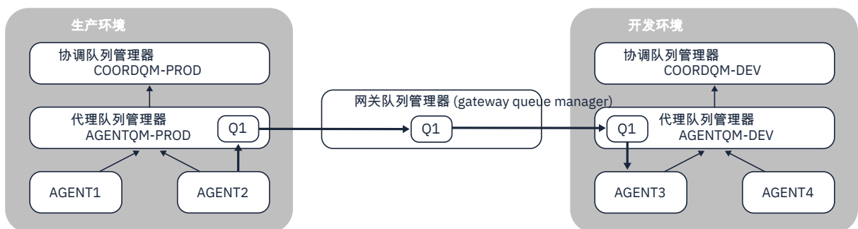
图 8: 在这里, AGENT2 连接到其代理队列管理器 AGENTQM-PROD, 并执行文件到消息传输以将消息写入名为 Q1 的队列。Q1 是远程队列, 因此消息通过 Gateway 队列管理器和发送方/接收方通道路由到队列管理器 AGENTQM-DEV 上的本地队列 Q1。然后, AGENT3 执行消息到文件传输以获取消息并将其引入到开发环境拓扑中。
