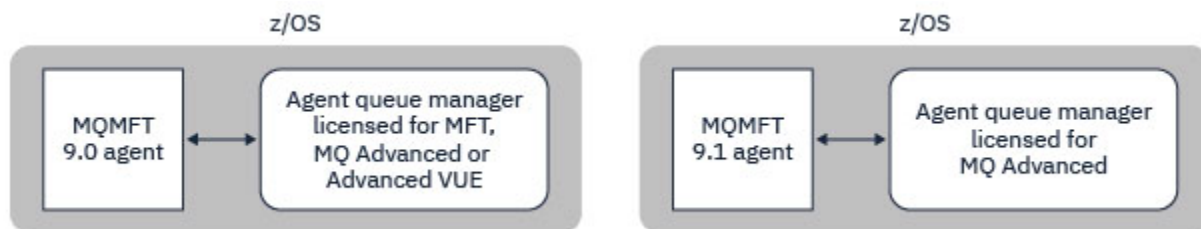
图 45: 具有针对 MFT 或 IBM MQ Advanced 许可的代理队列管理器的 z/OS 和 9.1 代理上的 MFT 9.0 代理必须使用 BINDINGS 传输进行连接。
