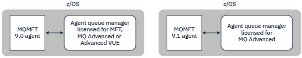
Şekil 45. MFT ya da IBM MQ Advanced için lisanslanan bir aracı kuyruk yöneticisine sahip z/OS ve 9.1 araçlarındaki MFT 9.0 araçları, BATICE (Bağlamalar) iletimi kullanılarak bağlantı kurulmalıdır.
