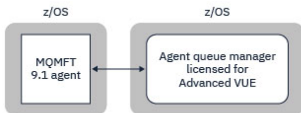
Figura 44. Agentes MFT 9.1 no z/OS podem se conectar a um gerenciador de filas usando o transporte CLIENTE, assumindo que o gerenciador de filas é licenciado para Advanced VUE.
