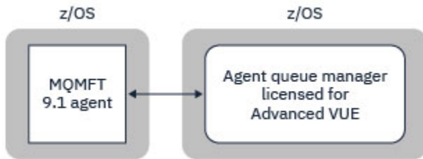
그림 44. z/OS의 MFT 9.1 에이전트는 클라이언트 전송을 사용하여 큐 관리자에 연결할 수 있습니다. 큐 관리자가 고급 VUE에 대해 라이선스가 부여된 것으로 가정합니다.
