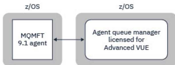
Figura 44. Gli agent di MFT 9.1 su z/OS possono connettersi ad un gestore code utilizzando il trasporto CLIENT, supponendo che il gestore code sia concesso in licenza per Advanced VUE.
