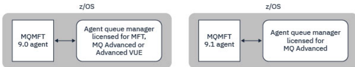
Figura 45. Gli agent MFT 9.0 su z/OS e 9.1 che hanno un gestore code dell'agent concesso in licenza per MFT o IBM MQ Advanced, devono connettersi utilizzando il trasporto BINDINGS.
