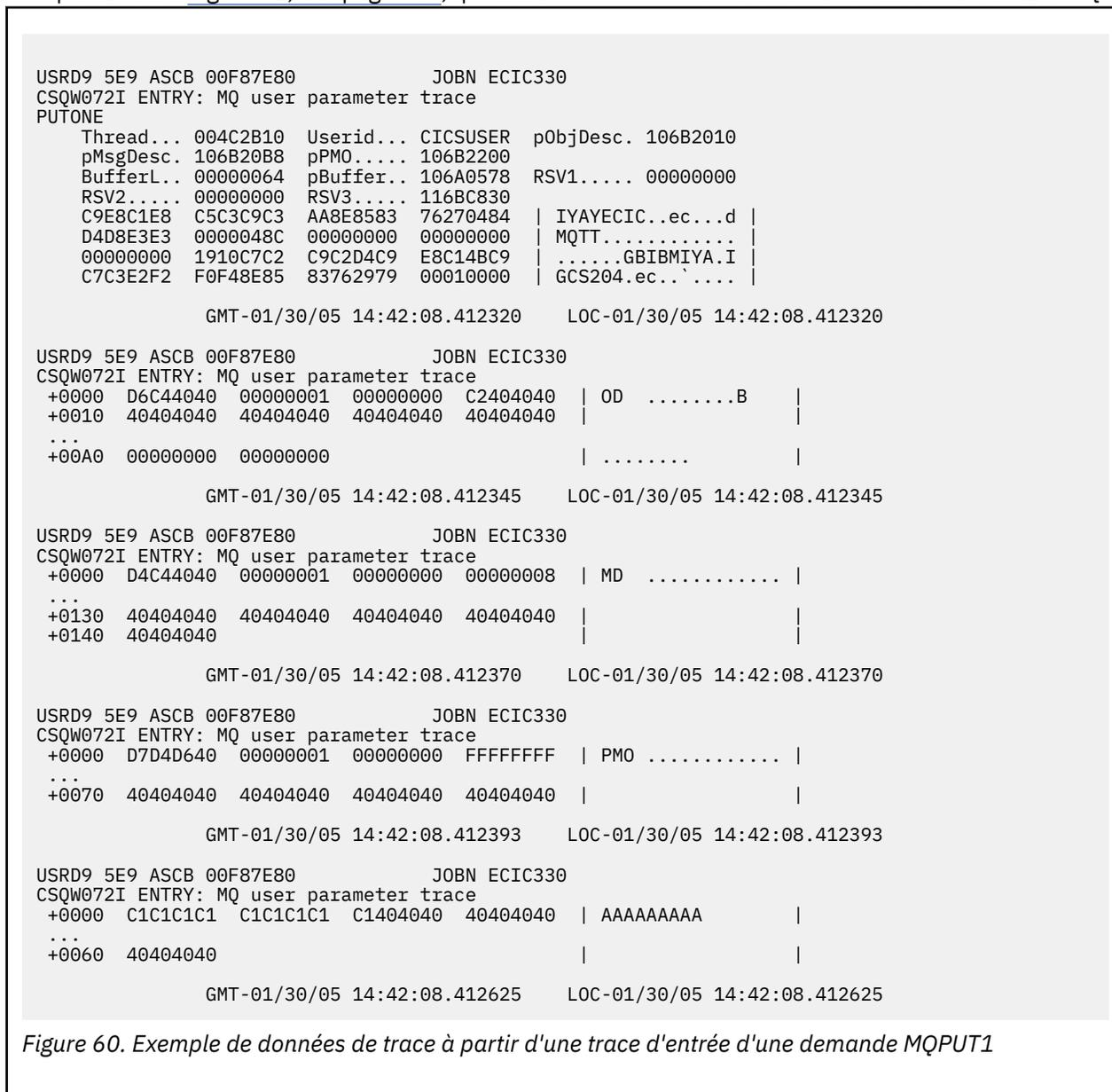
Figure 60. Exemple de données de trace à partir d'une trace d'entrée d'une demande MQPUT1
