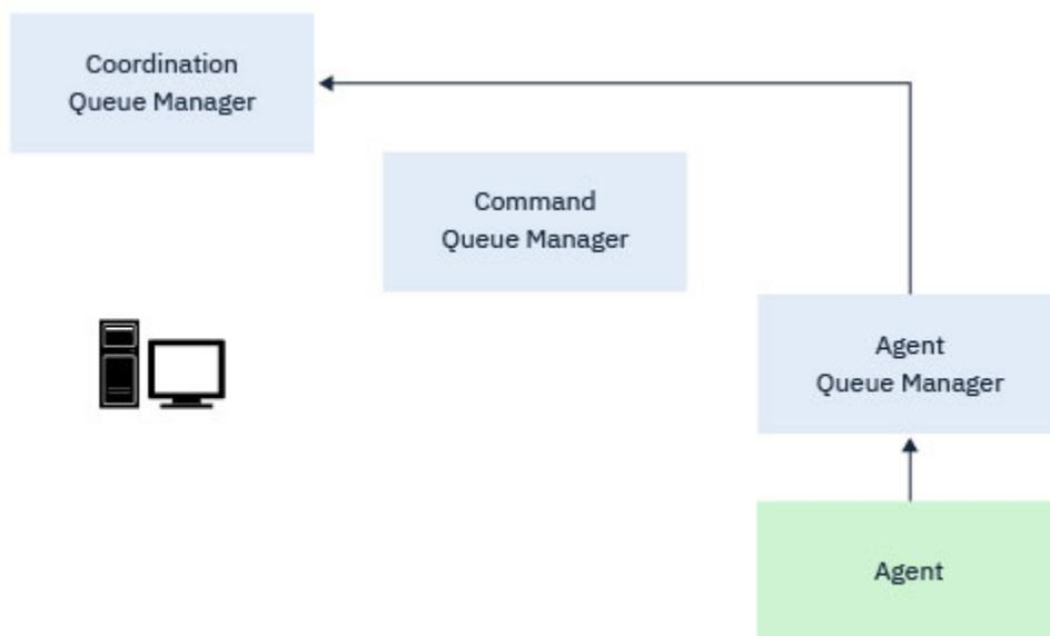
Figure 1. Les agents publient des informations de statut ou stockent des modèles de transfert sur le gestionnaire de files d'attente de coordination
