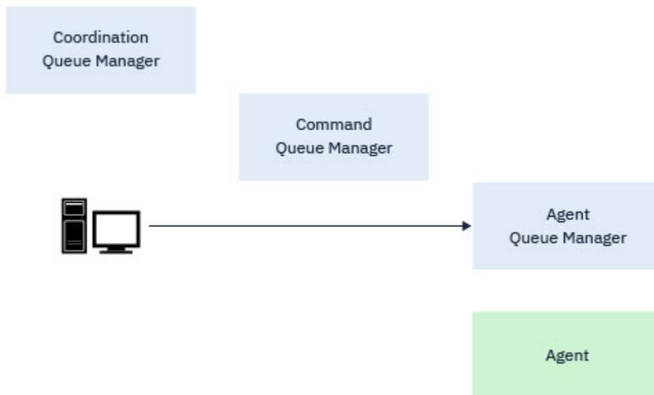
Figure 5. La commande **fteCleanAgent** se connecte directement au gestionnaire de files d'attente d'agent et supprime les informations d'état des files d'attente système de l'agent
