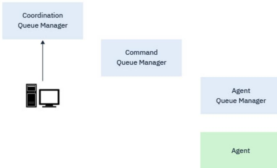
Figure 2. Les commandes se connectent ensuite directement au gestionnaire de file d'attente de coordination pour obtenir les informations de statut appropriées ou utiliser des modèles de transfert.
