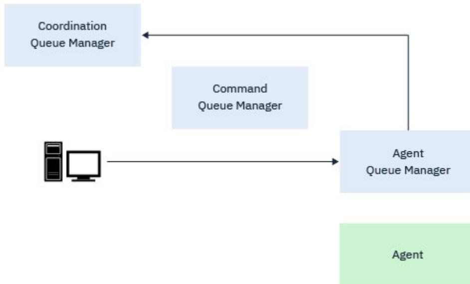
Figure 4. Les différentes commandes **fteCreate**, ainsi que la commande **fteDeleteAgent**, se connectent au gestionnaire de files d'attente d'agent et envoient un message au gestionnaire de files d'attente de coordination pour enregistrer ou désenregistrer un agent de la topologie.
