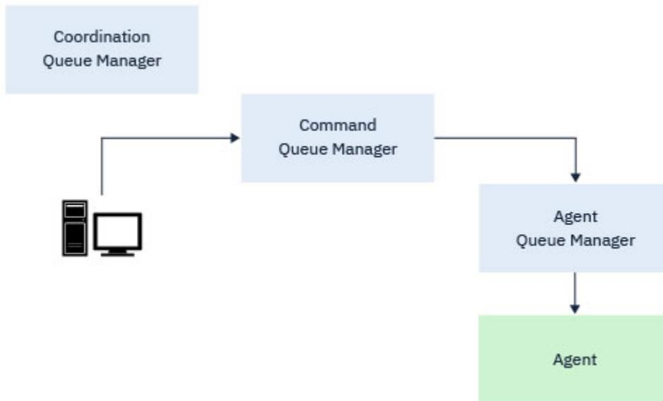
Figure 3. Les commandes se connectent au gestionnaire de files d'attente de commandes. Le message contenant la commande est ensuite acheminé via le réseau IBM MQ vers le gestionnaire de files d'attente d'agent approprié, où il est récupéré par l'agent.
