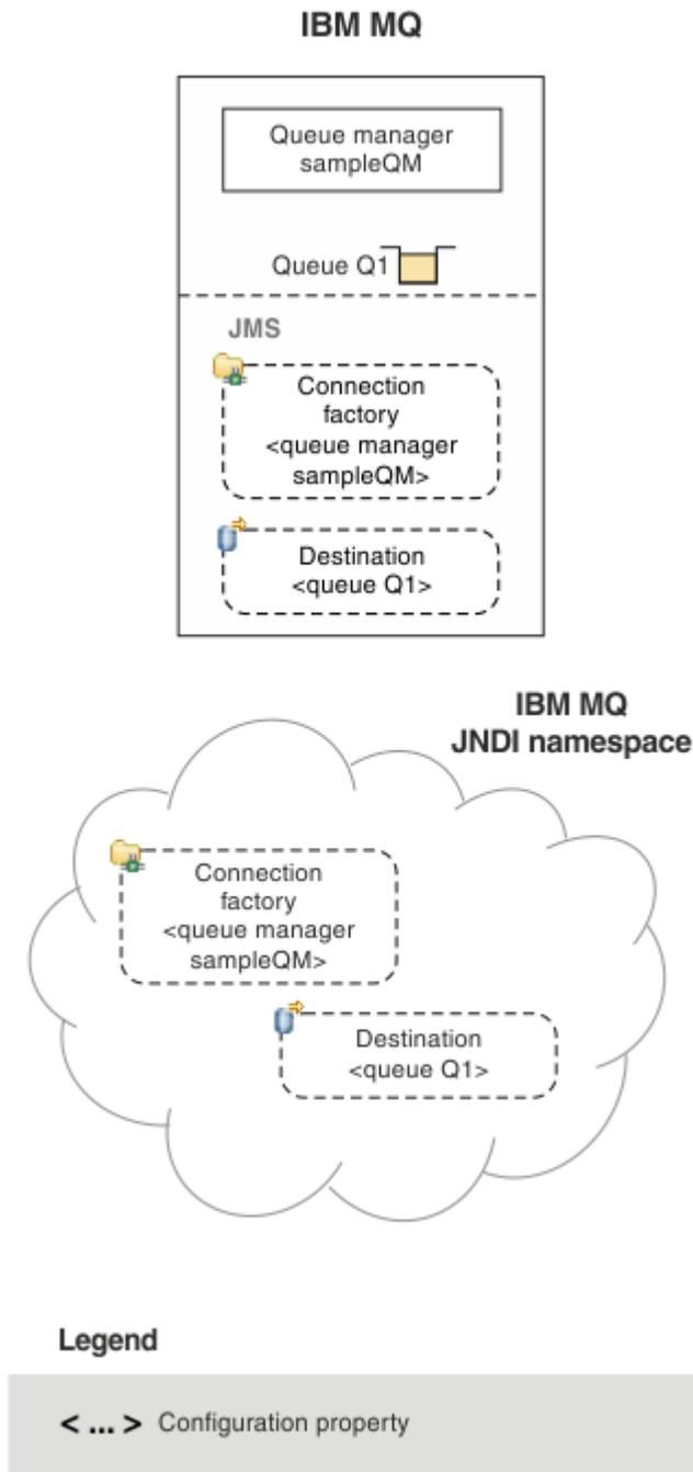
圖 89: IBM MQ 中建立的 JMS 物件
