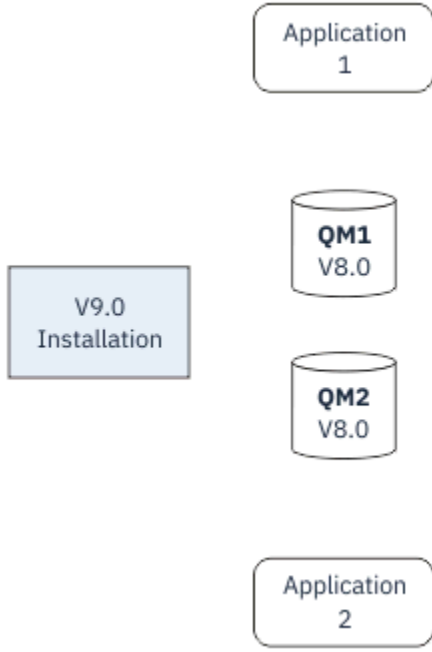
Şekil 3. Single_stage geçiş: daha sonraki sürüm kuruldu, ancak kuyruk yöneticileri henüz bağlanmadı ve henüz ilişkilendirilmemiş uygulamalar
