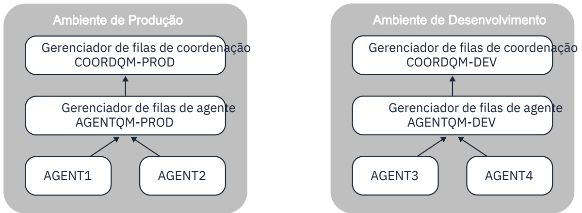
Figura 14. AGENT1 e AGENT2 fazem parte de uma topologia no ambiente de produção e AGENT3 e AGENT4 fazem parte da topologia do ambiente de desenvolvimento..
