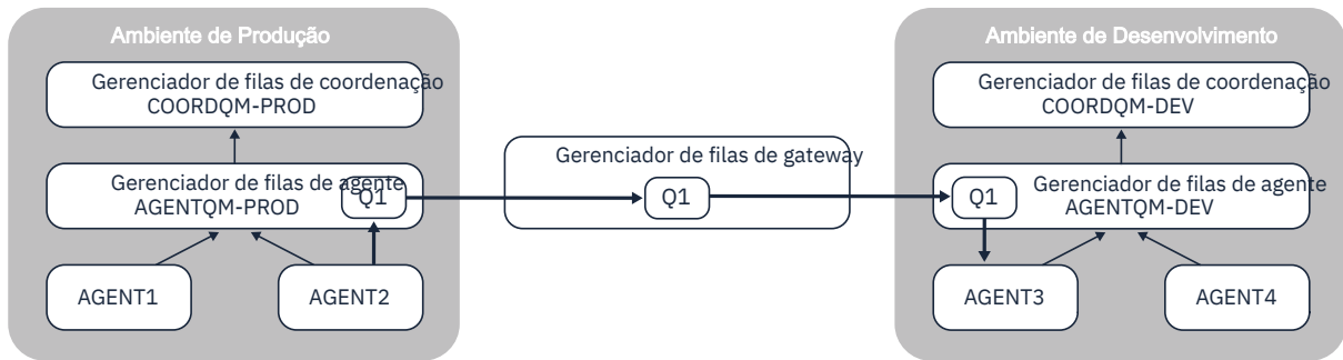
Figura 16. Aqui, AGENT2 é conectado a seu gerenciador de filas de agente AGENTQM-PROD e executa uma transferência de arquivo para mensagem para gravar uma mensagem em uma fila chamada Q1. Q1 é uma fila remota e, portanto, a mensagem é roteada por meio do Gerenciador de filas de gateway e dos canais emissor / receptor para a fila local Q1 no gerenciador de filas AGENTQM-DEV. AGENT3 então executa uma transferência de mensagem para arquivo para obter a mensagem e trazê-la para a topologia do Ambiente de Desenvolvimento.
