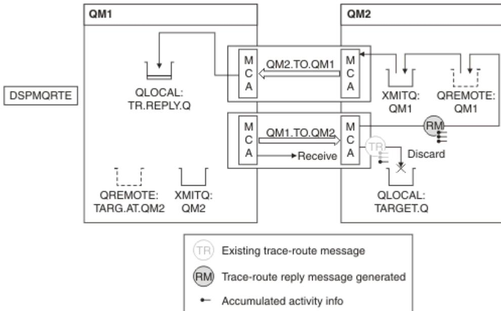
図 15. 経路トレース応答メッセージの要求、図 3
