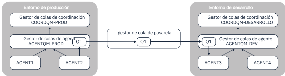
Figura 16. Aquí, AGENT2 está conectado a su gestor de colas de agente AGENTQM-PROD y realiza una transferencia de archivo a mensaje para grabar un mensaje en una cola denominada Q1. Q1 es una cola remota y, por lo tanto, el mensaje se direcciona a través del gestor de colas de pasarela y de los canales emisor/receptor a la cola local Q1 en el gestor de colas AGENTQM-DEV. A continuación, AGENT3 realiza una transferencia de mensaje a archivo para obtener el mensaje y llevarlo a la topología de entorno de desarrollo.
