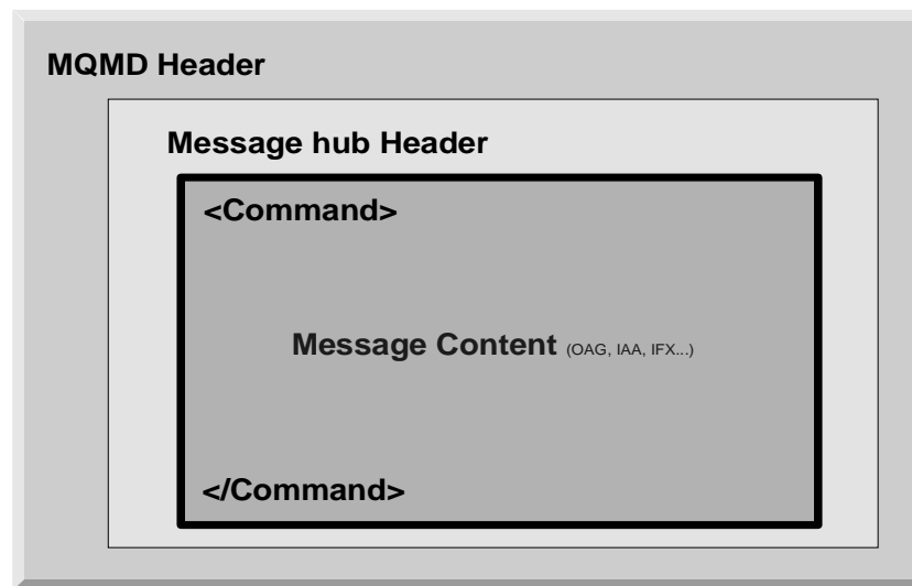
Figure 3: WMQI Enabler message structure for IAA.
