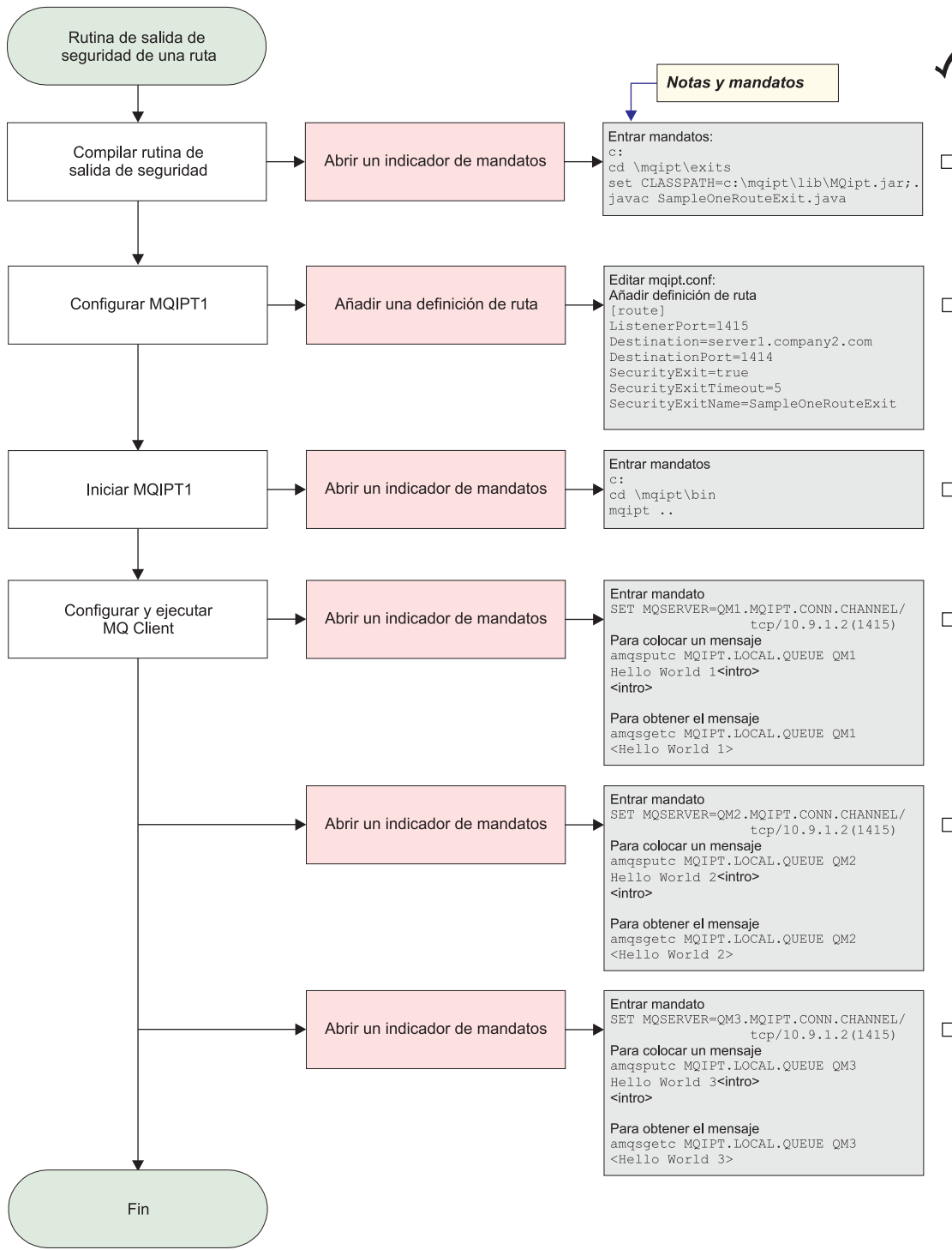
Figura 45. Configuración de la rutina de salida de una ruta dinámica
