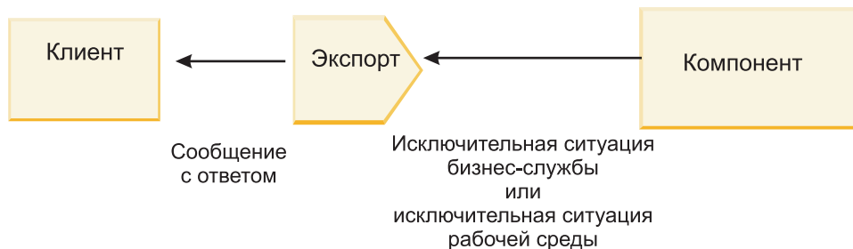
Рисунок 8. Как информация о сбое передается из компонента в клиент через привязку экспорта
