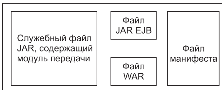
Рисунок 44. Упрощенный пример файла EAR, содержащего модуль передачи. Файл EAR содержит файлы JAR. Файл JAR утилита содержит модуль передачи.
