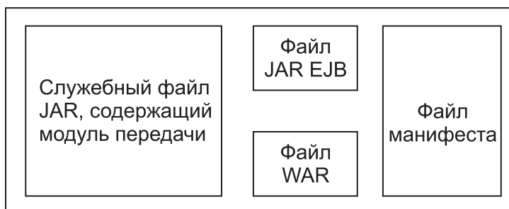
Рисунок 44. Упрощенный пример файла EAR, содержащего модуль передачи. Файл EAR содержит файлы JAR. Файл JAR утилит содержит модуль передачи.
