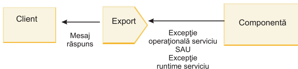
Figura 8. Cum sunt trimise informațiile despre defect de la componentă prin legarea de export clientului
