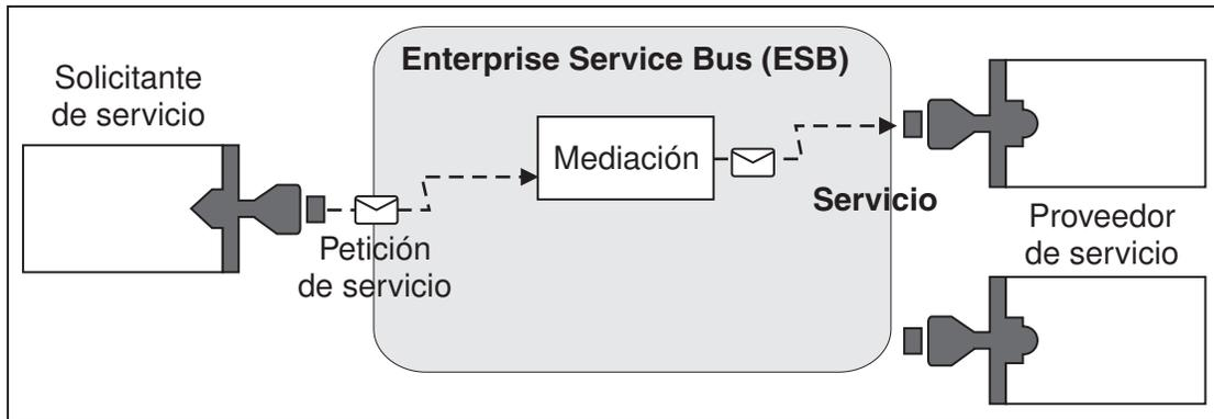
*Figura 42. Bus de servicio empresarial.* El bus de servicio empresarial direcciona los mensajes entre las aplicaciones, que son solicitantes o proveedores de servicios. El bus convierte los protocolos de transporte y transforma los formatos de mensajes entre los solicitantes y los proveedores. En esta figura, cada aplicación utiliza un protocolo distinto (representado por las distintas formas geométricas de los conectores) y utiliza formatos de mensajes distintos.
