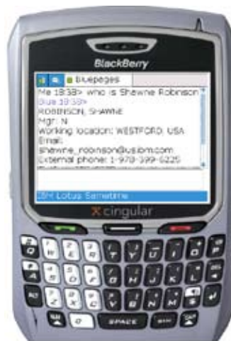
Figure 4. Exemple d'accès par robot à l'annuaire d'entreprise à partir du client mobile de Lotus Sametime s'exécutant sur un appareil RIM BlackBerry.
