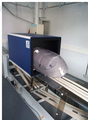
Exemple avec tunnel pour articles en vrac (photo Tagsys)
