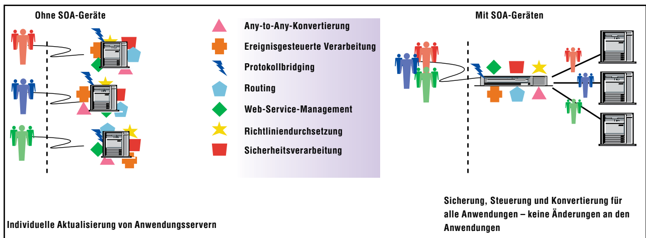
Abbildung 1. SOA-Geräte zentralisieren und vereinfachen die Verwaltung von Web-Services und SOA-Governance.
