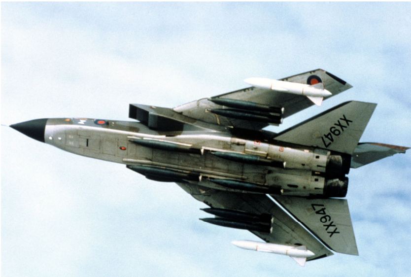
Tornado GR4 der britischen Royal Air Force – gut sichtbar sind die modularen Waffenaufhängungen, die sich verschieden ausrüsten lassen
