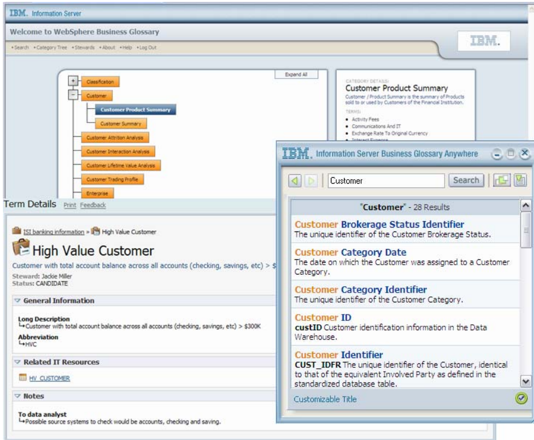
Abbildung 9: Drei Sichten auf das Business Glossary. Im Hintergrund zu sehen ist die Hierarchie des Objektes „Customer“, rechts das Ergebnis aus einer Suche im Business Glossary aus der man per Mausklick auf die Detailansicht zu einem Objekt wechseln kann, links unten sind Detailinformationen zu einem Geschäftsbegriff zu sehen mit Beziehungen zur verwendeten Datenbank-Tabelle.
