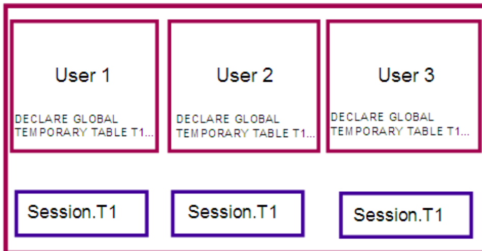
Figure 8.5 – Scope of declared global temporary tables / Figura 8.5 - Scope di tabelle provvisorie dichiarate globali
