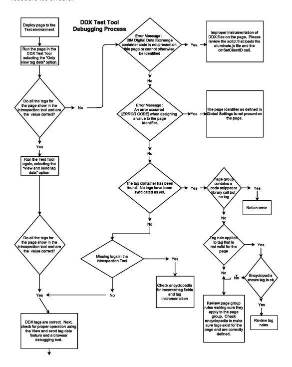
Illustration 1 : Diagramme des processus de débogage et d'identification et de résolution d'incident de l'outil de test
