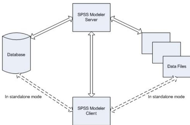
Рисунок 1. Архитектура IBM SPSS Modeler Server
