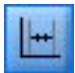
Figura 52. L'icona di divisione utilizzata per espandere la barra degli strumenti con opzioni relative alla suddivisione in sezioni
