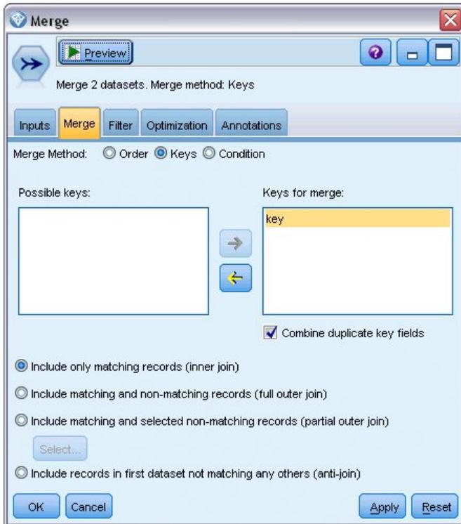
Figure 19. Spécification du champ-clé pour la fusion
