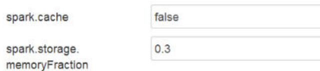
圖 2. 自訂 analytics.cfg Spark 快取設定
