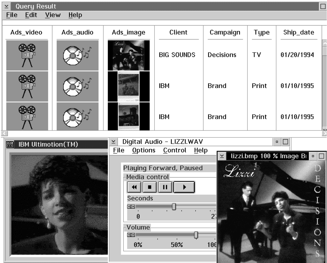
図1. マルチメディア・データベース表。この表には、従来のデータ・タイプの他に、画像、音声、ビデオのデータが入ります。ビデオ、音声、画像が示されます。
