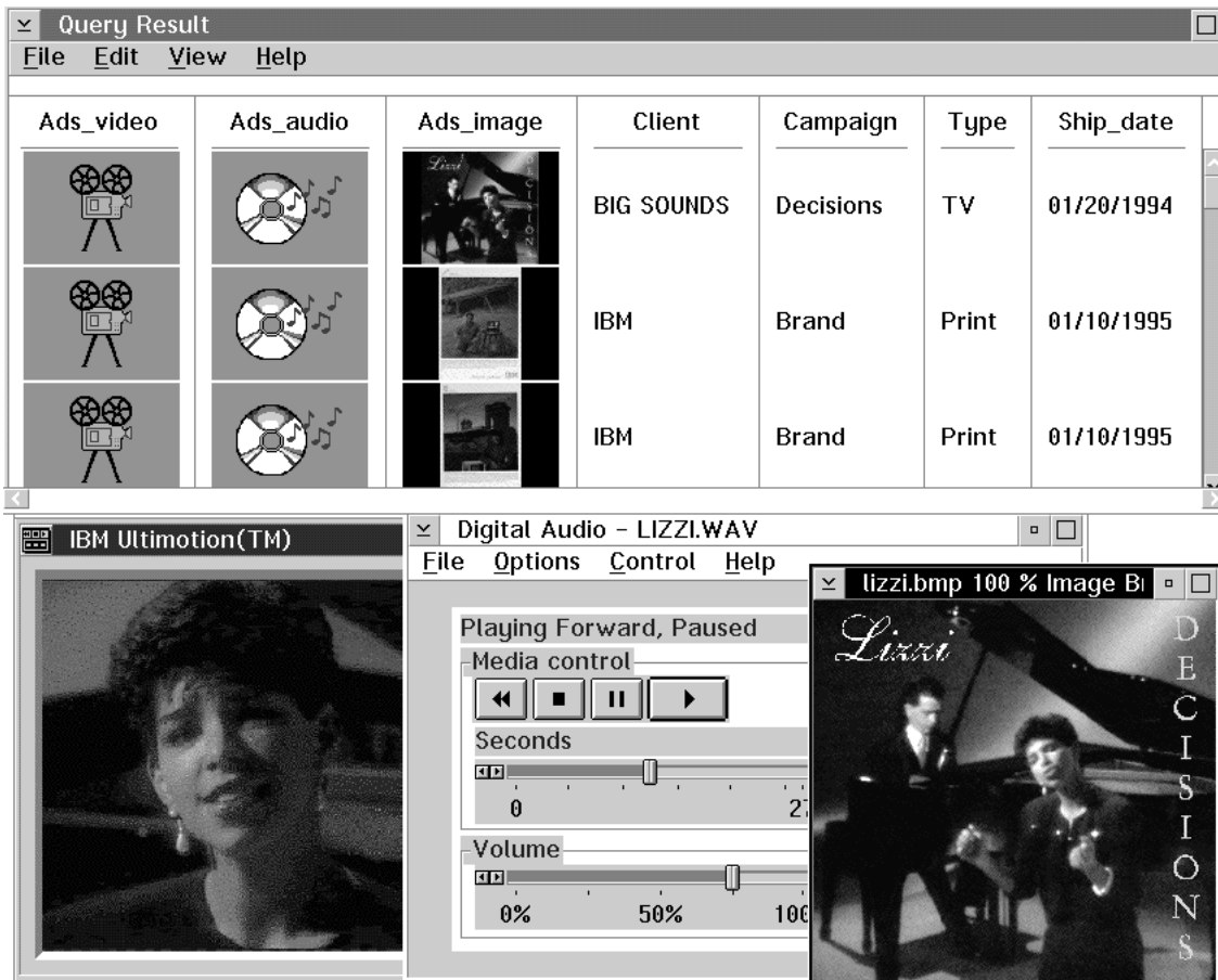
Figure 1. Table de base de données multimédia. Cette table contient des données de type image, audio et vidéo, ainsi que des données alphanumériques classiques. Une séquence vidéo, un flash audio et une image sont représentés sur la figure.
